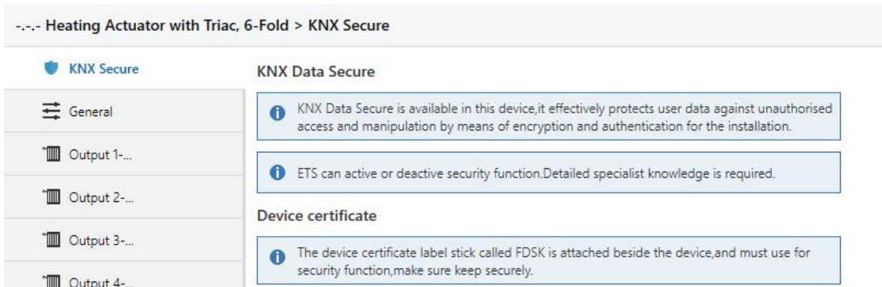
图 5.1 (1) “KNX Secure” 参数界面
